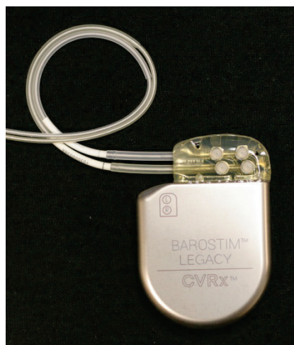
Abbildung 10: Korrekte Platzierung des überschüssigen Ableitungskörpers
