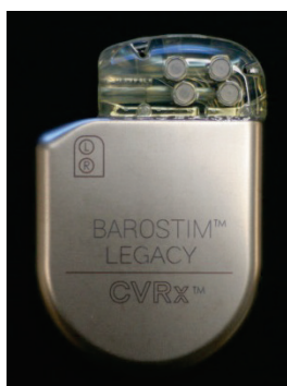
Figura 2: Generatore di impulsi impiantabile
