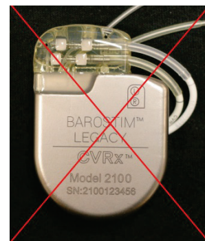
Posizionamento errato della derivazione dietro IPG
