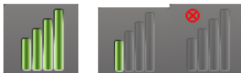
Afbeelding 10: Indicator van verbindingsskwaliteit (uitstekend, slecht, geen verbinding)
